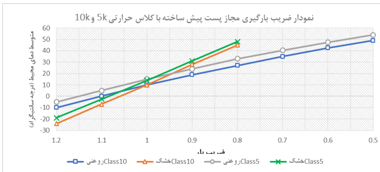
شکل ۵: نمودار کلاس حرارتی پست پیش ساخته نوع خشک و روغنی
